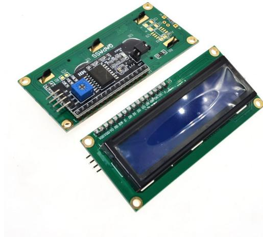
FIGURE 3.7 : Afficheur LCD I2C 16\*2
