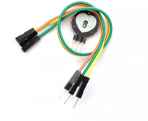
**FIGURE 3.2 :** Pulse Sensor
