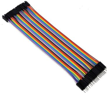
FIGURE 3.6 : Fils De Connexion
